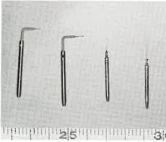
写真1 左2本は著者が使用する針先の一部をテフロン加工した電気針、右2本は従来の電気針
