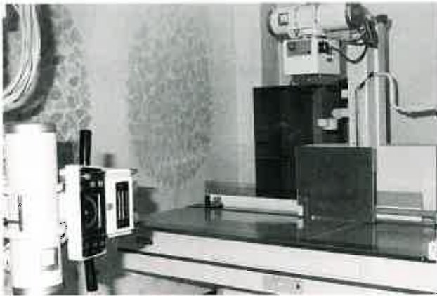
図5a 右上は透視用X線管・左下は単純撮影用X線管
